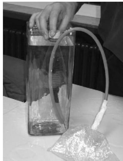
Anschließende Volumenmessung in einer Wasserwanne
