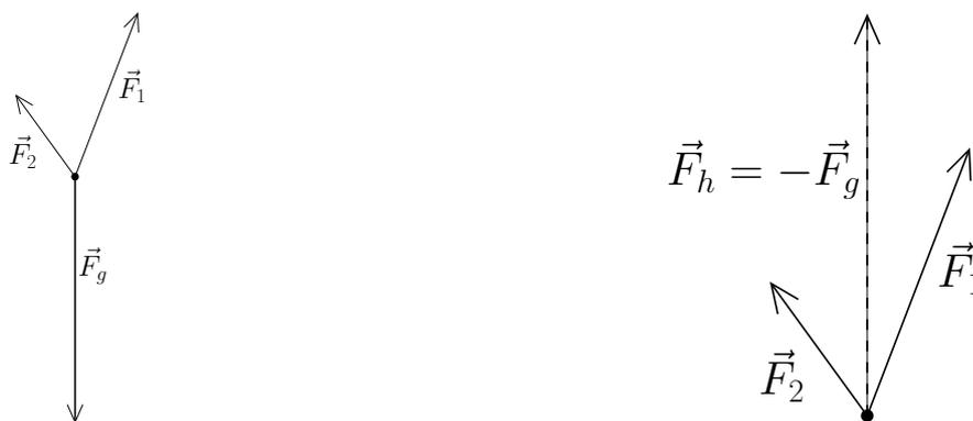
Abbildung 2: Vergleich der beiden Möglichkeiten, aus einer Zeichnung die Regel zur Vektoraddition abzuleiten.
